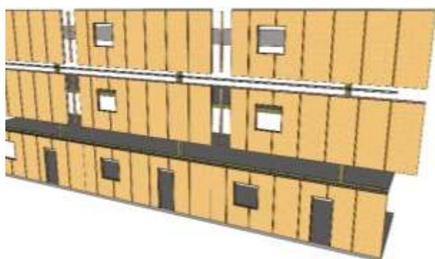
**Figure 20 – Pose de l'ensemble des panneaux (mode de pose 1)**
