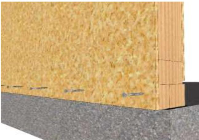
**Figure 14 – Vissage du pied de panneau de façade LogiSkin à la lisse d'implantation (mode de pose 1)**
