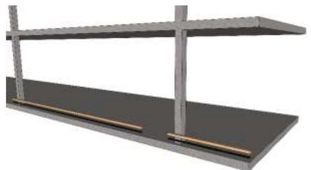
**Figure 11 – Mise en œuvre des lisses d'implantation sur bande d'arase au niveau de la première dalle (mode de pose 1)**
