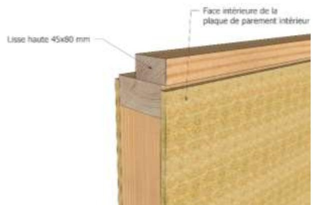
**Figure 9 – Lisse haute fixée sur la traverse haute des panneaux, uniquement dans le cas du mode de pose 1**
