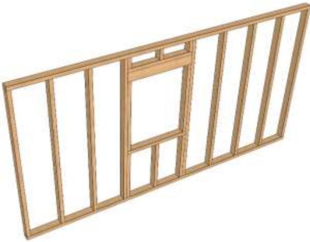
**Figure 6 – Vue de l'ossature bois intérieure d'un panneau de façade LogiSkin®**
