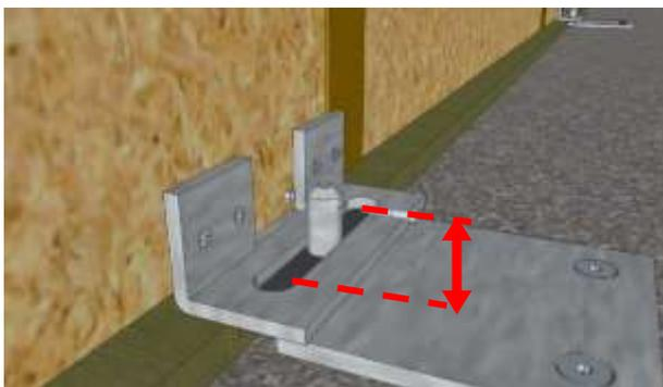
33 mm = longueur disponible jusque sous la goupille, permettant de cumuler 20 mm de hauteur de cales + 8 mm épaisseur de la "poignée"
