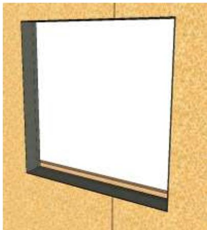
**Figure 43 – Pose d'une bande de pare-pluie périphérique au droit de l'embrasure**
