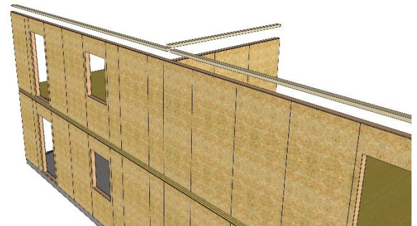
Figure 22 – Mise en œuvre des lisses sablières de chaînage, vissées sur les traverses hautes en tête de panneau de mur
