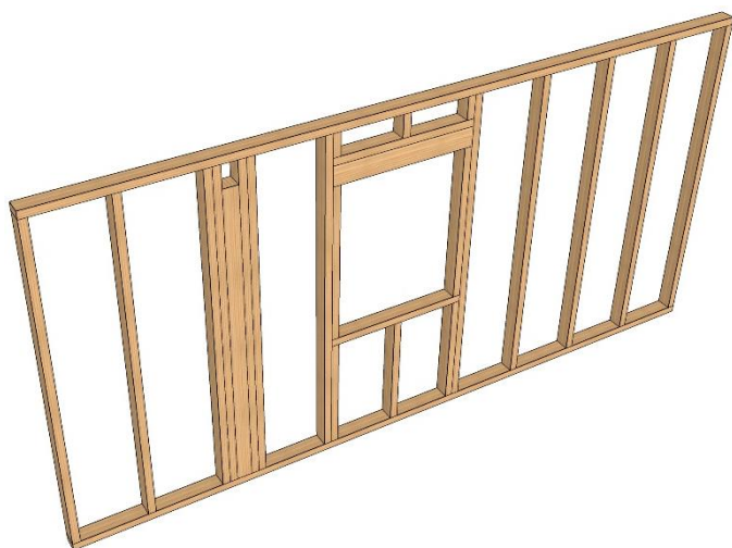
Figure 7 – Vue de l'ossature bois intérieure d'un panneau de mur LogiWall®
