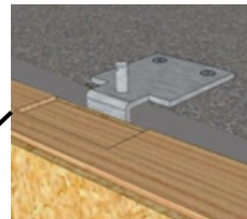
Mise en butée du panneau contre le plat vertical de la platine support
