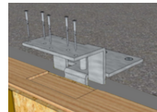
Mise en œuvre et fixation de la bride du système d'ancrage LOGIFIX
