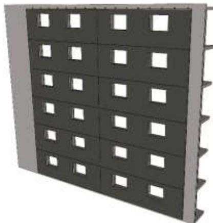
**Figure 16 – Pose de l'ensemble des panneaux des différents étages en suivant le même process de pose que les étapes précédentes – Mode de pose 1**
