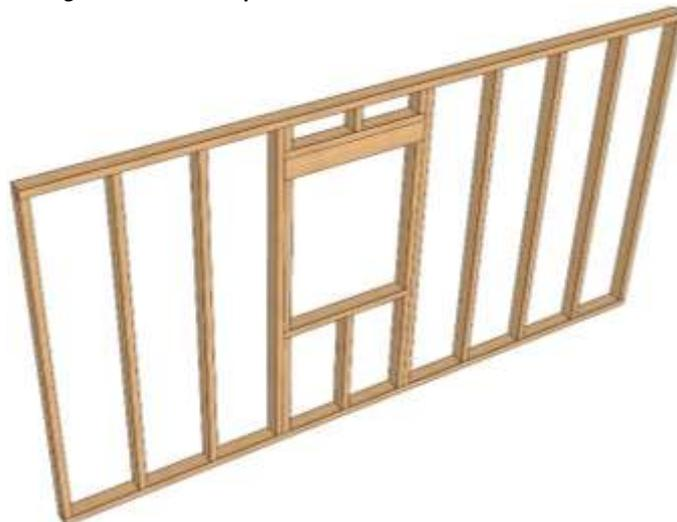
Figure 6 – Vue de l'ossature bois intérieure d'un panneau de mur manteau LOGISKIN-R®
