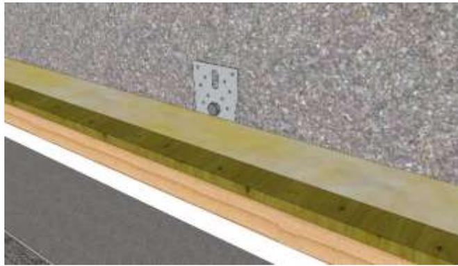
**Figure 19 – Mise en œuvre d'un isolant de calfeutrement compressible entre panneaux – Mode de pose 2**
